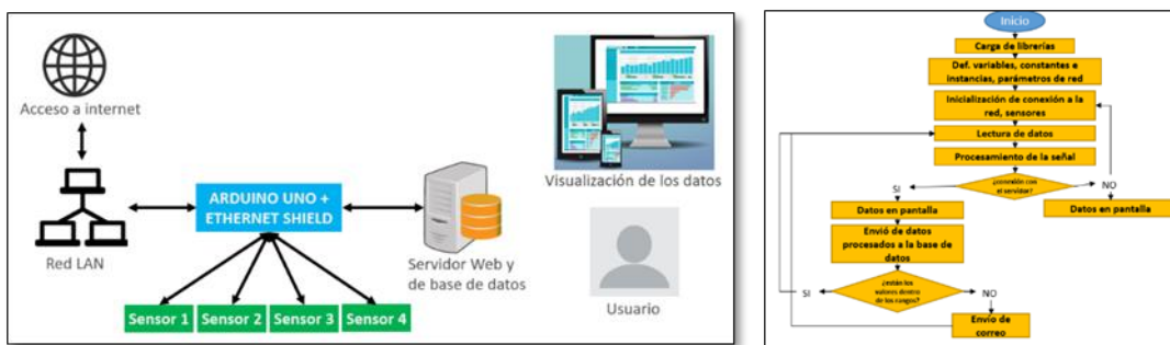
Figura 1. Diseño del sistema y diagrama de flujo. Fuente: el autor.
