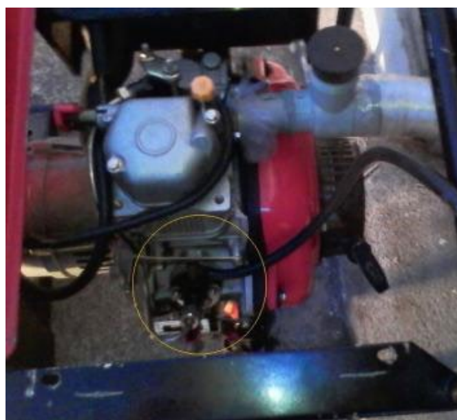
Figura 2. Adaptación manguera de admisión de combustible.
