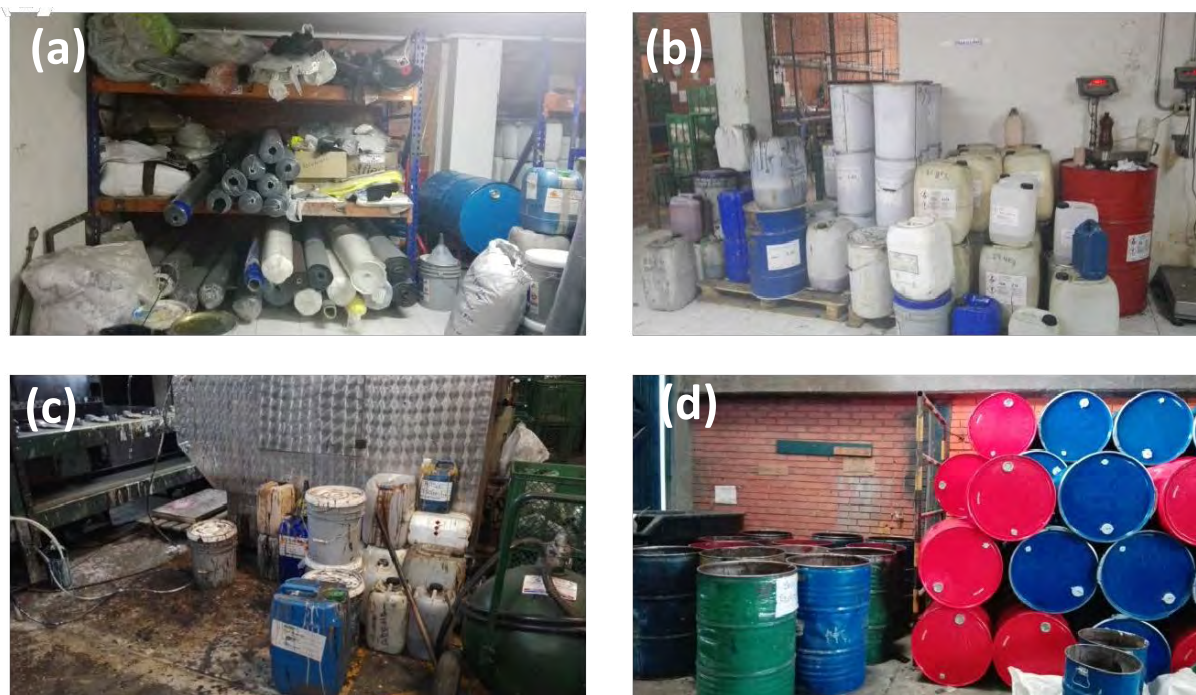
Figura 4. Almacenamiento de insumos y sustancias químicas: (a) Almacén – rollos de tela, plástico al lado de sustancias químicas, (b) Almacén – Pinturas y poliol sin estibar ni etiquetar, (c) Cabina de pinturas – sin etiquetas y (d) Zona de disposición final – Tinas desocupadas con tinas llenas de sustancias químicas.
