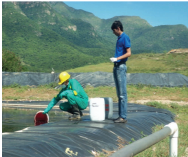
Figura 1. Recolección de muestra de lixiviado.
