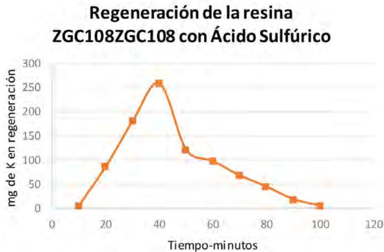
**Figura 5.** Regeneración: Disminución de potasio en resina con respecto al tiempo para el ensayo 1.
