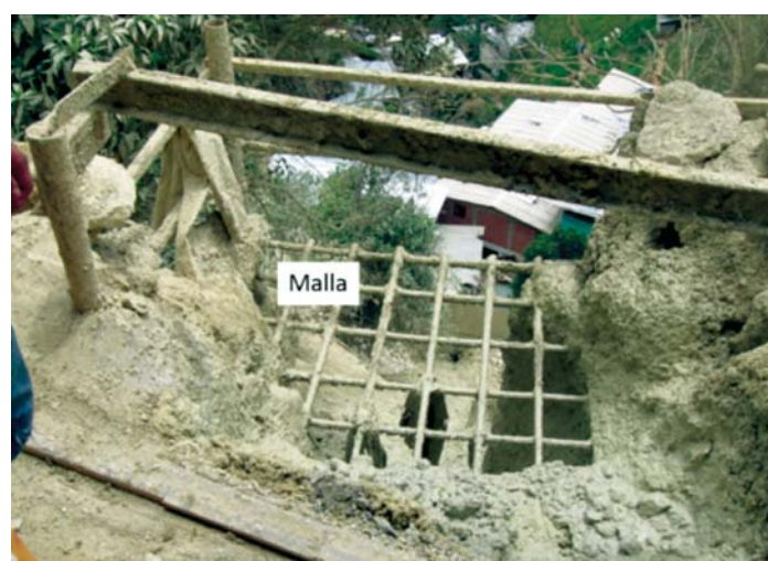
Figura 2. Malla de selección 20x20 cm para el paso del material con mayor porcentaje de oro.
