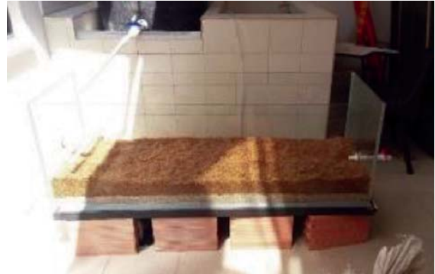
2. Primera capa de sustrato (grava y cascarilla de arroz).
