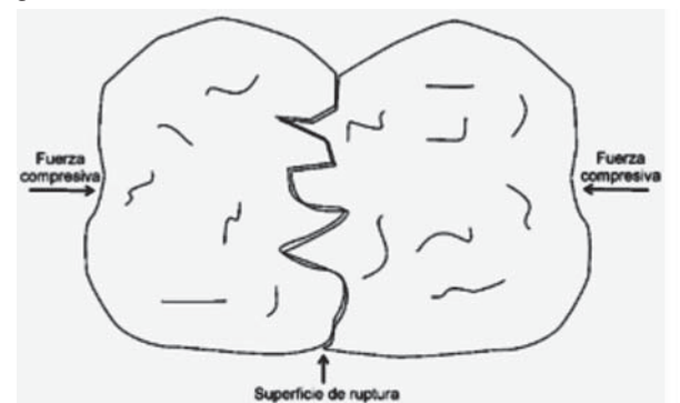
Figura 5. Esquema de agregado de suelo sometido a rompimiento en el ensayo de resistencia a la compresión.
