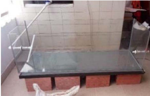
1. Estructura en vidrio y tuberías de entrada y salida de agua
