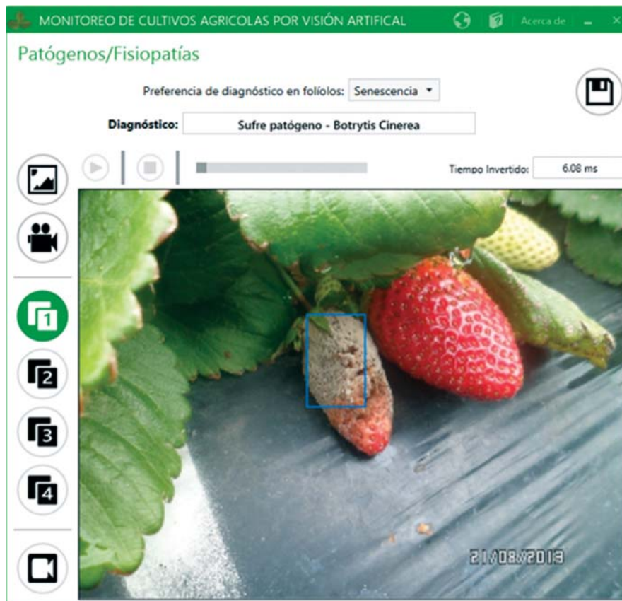
Figura 6. Ejecución del algoritmo en la GUI, entregando al usuario un diagnóstico de Botrytis sp.
