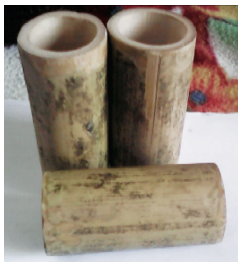
Figura 6. Probetas de GAK para ensayo a compresión.
