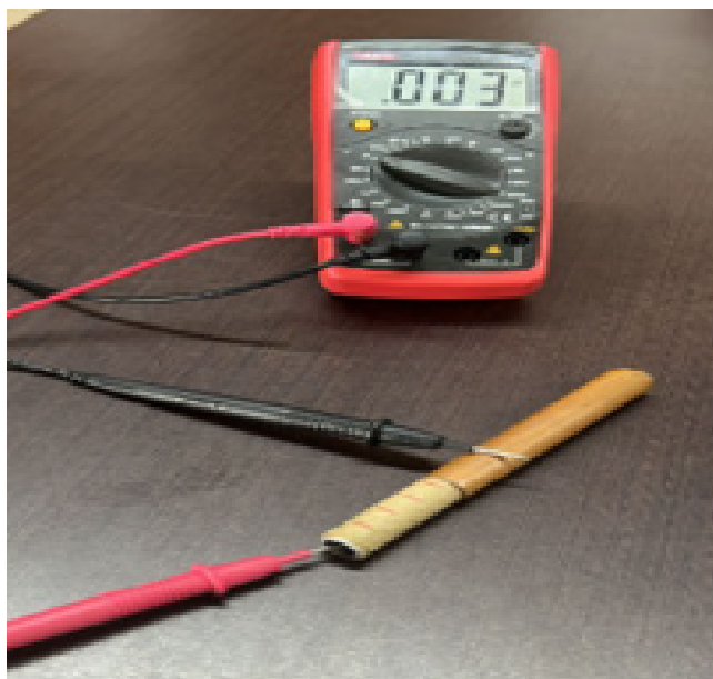
Fig. 5. Fotografía del equipo utilizado al medir la capacitancia en un capacitor cilíndrico con material dieléctrico papel.
