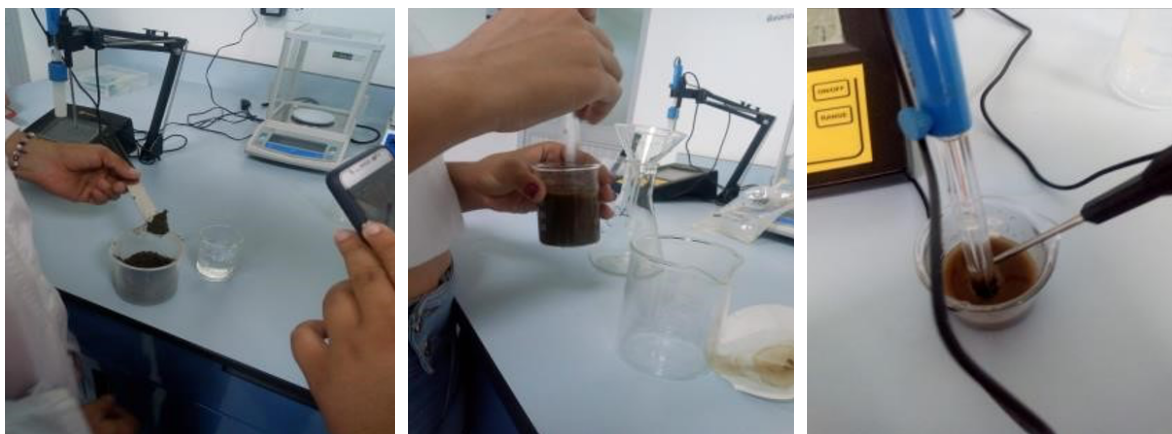
Imagen 2. Proceso de disolución de la muestra en agua y utilización del pH-metro
