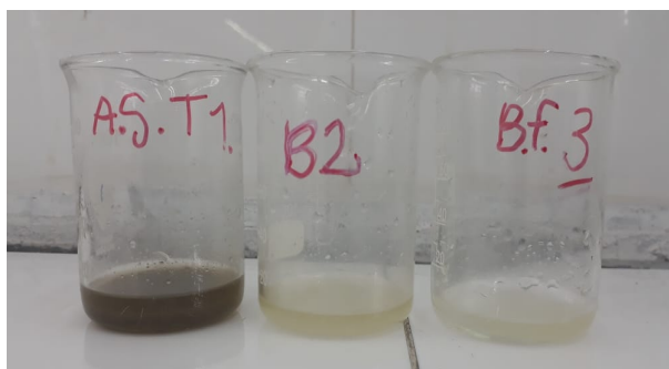
Ilustración 3. Determinación de grasas y aceites tratadas con diversos procesos 1. Agua sin tratamiento, 2. Bacterias, 3. Bacterias y filtro.
