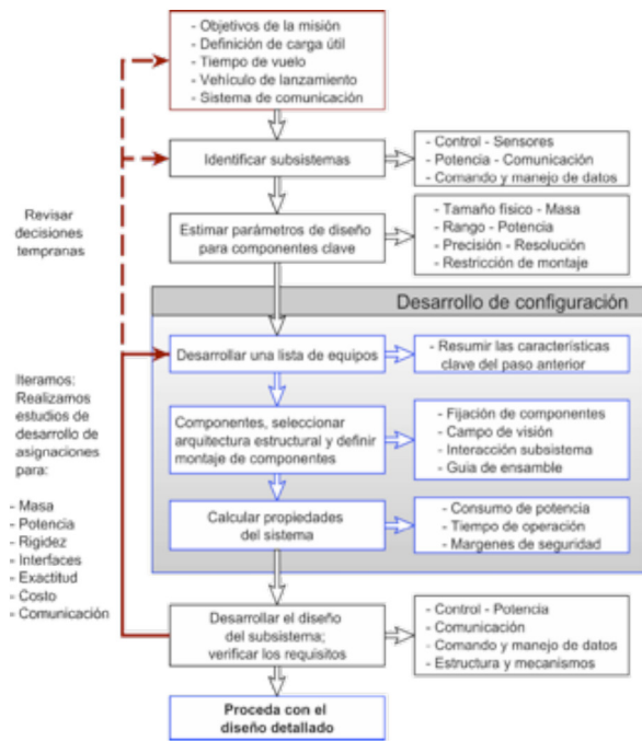
Fig. 1. Método de diseño preliminar del satélite.
