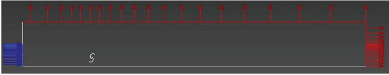
Figura 4. Condiciones de contorno y dominio de simulación
