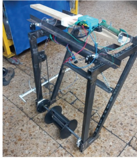
Figura 9. Prototipo de turbina hidrocínética tipo Savonius
