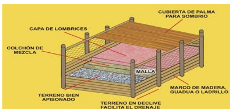
Figura 6. Características estructurales de las camas. Fuente: Sánchez (2010).
