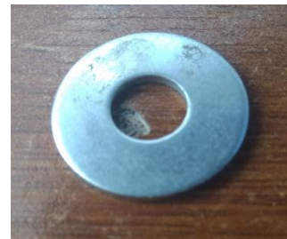
Ilustración 11. Imagen de una arandela, de la cual se extrajeron sus características
