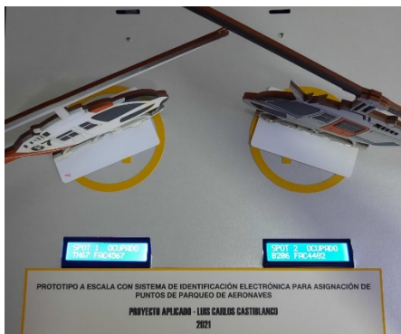
Figura 7. Prototipo a escala leyendo los tags de las aeronaves sobre los spots Fuente. Elaboración propia
