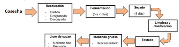
Figura 3. Diagrama de proceso artesanal para la producción de chocolate y sus derivados.
