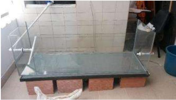
1. Estructura en vidrio, tuberías de entrada y salida de agua
