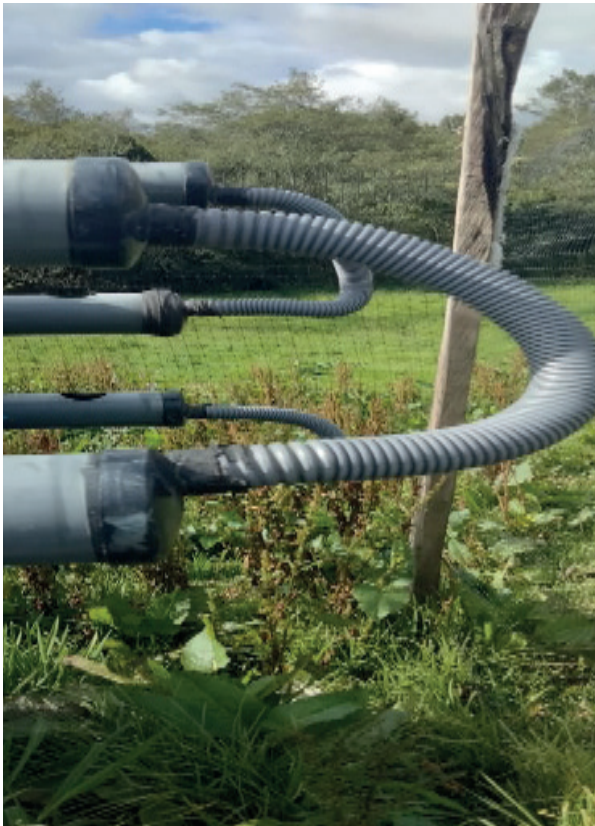
Figura 3. Tapas y manguera de drenaje encargadas de la recirculación
