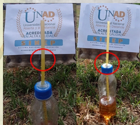
Fotografía 1. Termoscopio con temperatura por debajo de su capacidad. Tomada por el autor.
